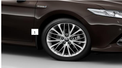
1. Калници - дизајнирани за монтажа во поткрилото на тркалото за да се заштити од вода, кал и камчиња. Напред - назад.
